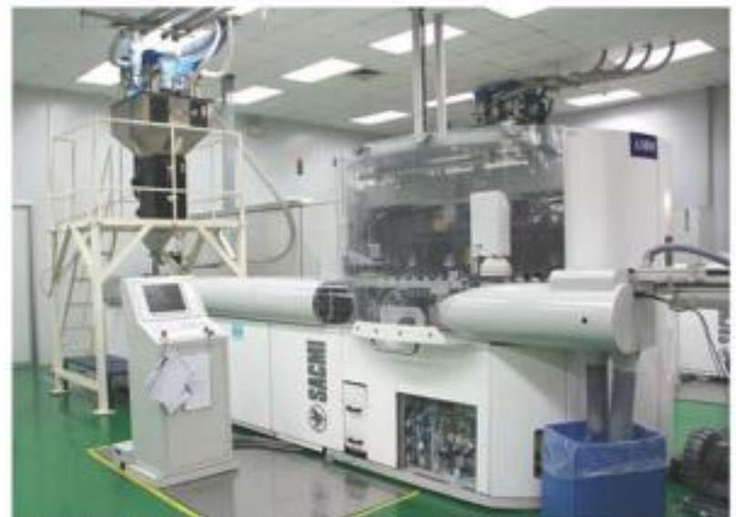
電腦控制塑膠瓶蓋自動生產線－壓模型 Plastic Closure Compression Machine
